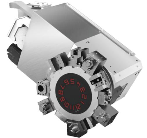
采用伺服分度、牙盘定位的结构，不仅具有良好的刚性，而且还具有很高的分度速度。刀塔分度动作可以和坐标运动同时进行，进一步提高了机床的工作效率。动力传动齿轮采用油气润滑，最高转速可达4000-6000rpm。高刚性的刀塔结构可得到很高的加工表面质量。
